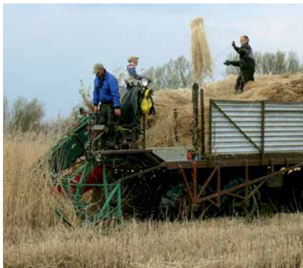
ABBILDUNG 5.39 ▶ Die Ernte von Schilfbeständen zur Gewinnung von Dachreet erfordert Spezialtechnik, die mit großen Ballonreifen oder Raupenlaufwerken an die geringe Tragfähigkeit der nassen Moorböden angepasst ist. (Foto: S. Wichmann)
